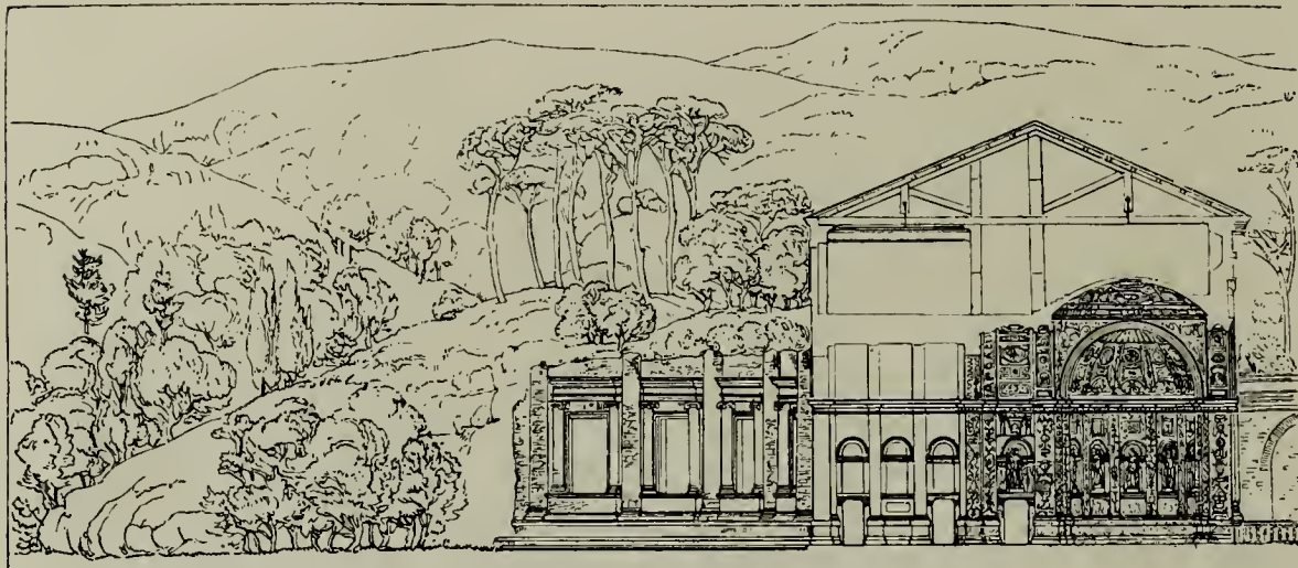
Abb. 249. Villa Madama zu Rom; Durchschnitt des Gebäudes und des halbrunden hintern Hofes.
